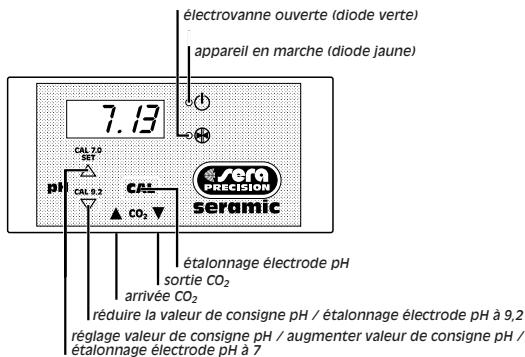
Des diodes indiquent si l'appareil est sous tension et si la vanne de dosage du CO<sub>2</sub> est ouverte.
