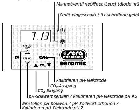
Über Leuchtdioden wird angezeigt, ob die Versorgungsspannung eingeschaltet ist und ob das Dosierventil für CO<sub>2</sub> geöffnet ist.
